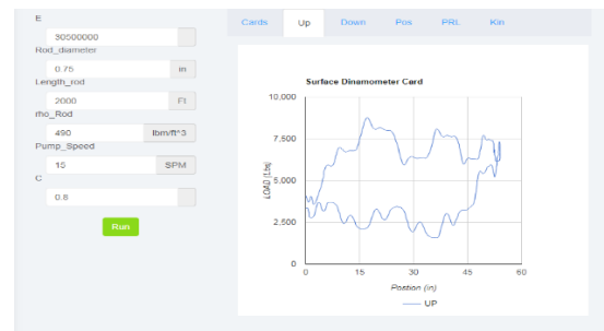
Figura 1: Vista de Carta dinamografica de superficie. Fuente: Valdez (2020)
