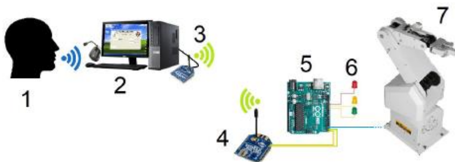
Figura 42. Representación gráfica del sistema de transmisión inalámbrico activado por comando de voz para el brazo robótico LabVolt de la Universidad Fermín Toro. Fuente: López (2020).
