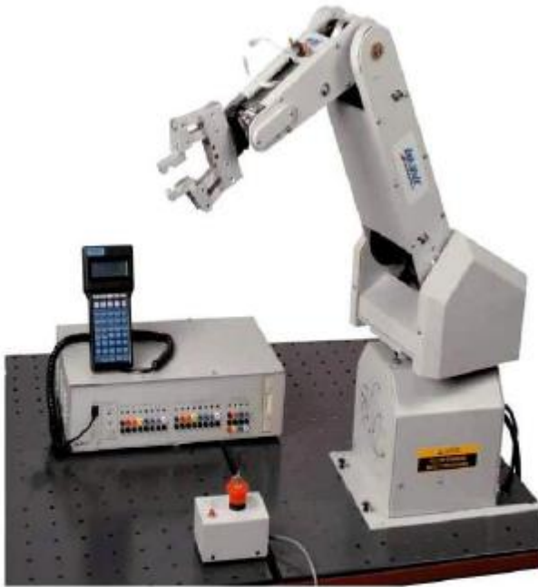
Figura 41. Brazo robótico articulado con unidad de control y cableado. Fuente: FESTO
